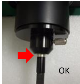
圖 9：光導管與準直鏡連接
